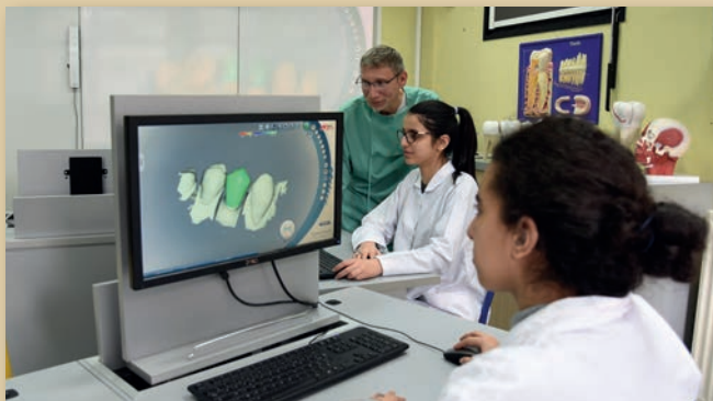
ORDINATEUR ÉQUIPÉ D'UN LOGICIEL DE CAO DENTAIRE ET SCANNER
